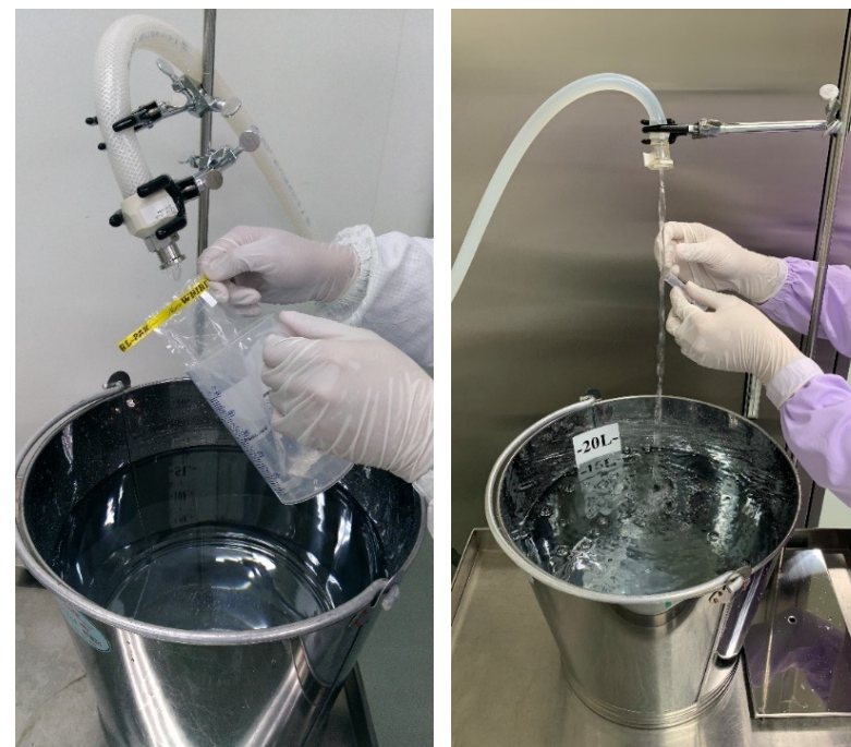
監測人員執行水系統監測採樣，根據不同水質採樣點位使用不同管件
