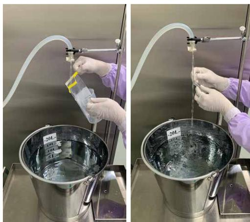
▲圖 9 監測人員執行水系統監測採樣，根據不同水質採樣點位使用不同管件
