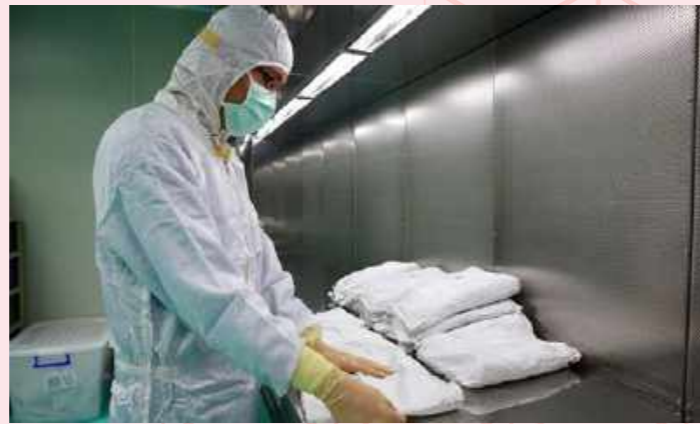
圖 11 / 在無菌製程中，人員的穿著都必須符合規範。避免皮膚暴露於環境中、單次穿脫使用滅菌的衣物，也不能將暴露於較低環境級區的器具直接帶入較高環境級區作業
