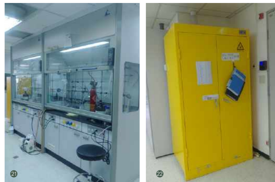
圖 21 / 毒化物運作需在抽氣櫃內執行 圖 22 / 依列管毒化物特性分類為第 1 類、第 2 類、第 3 類毒、第 4 類毒化物（註）及先驅化學品，分別存放於安全的抽換氣防爆櫃
