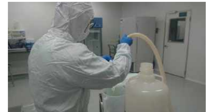
圖 13 / 監測人員依據【水系統取樣點圖示】執行日常水質監測
