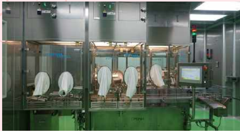
圖 10 / 位於 A 級潔淨區的自動化充填機。A 級潔淨區所在區域以綠色地面鋪設，以方便與不同環境區域 (B、C、D 等級) 作區隔。操作人員皆使用手套箱進行必要之輔助
